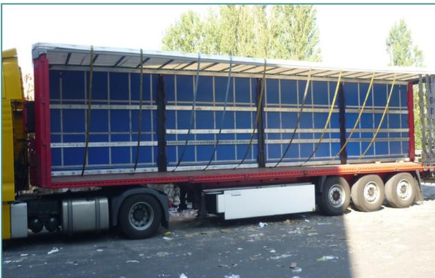
Рис. 3. Подготовленные крепежные ремни
