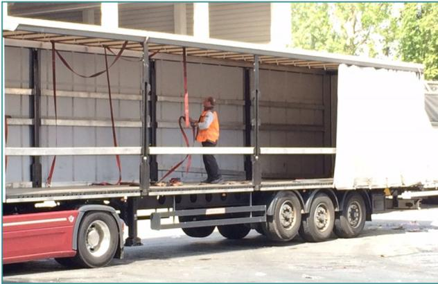
Рис. 2. Подготовка крепежных ремней водителем грузового автомобиля
