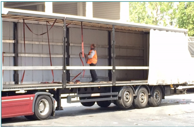
Imaginea 2 - Pregătirea chingilor de către șoferul camionului
