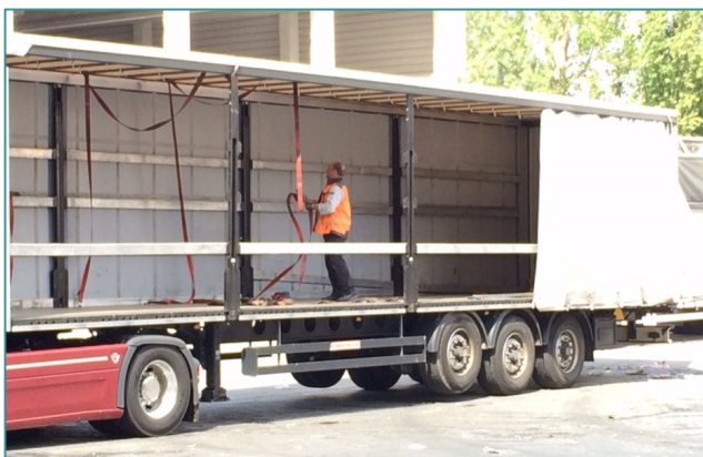
Abbildung 2 - Vorbereitung der Zurrgurte durch den LKW-Fahrer
