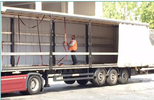
Figura 2: Preparación de las cintas de amarre por parte del conductor del camión
